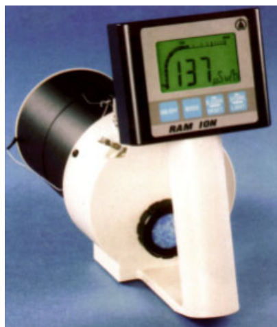
Figura 6.6 - Câmara de ionização, portátil, tipo “babyline”, com faixa de medição de 0,1 mR/h a 50 R/h ( 1 \mu\text{Sv/h} a 500 mSv/h), para detecção de radiações X, gama e beta, em instalações nucleares, clínicas de medicina nuclear, radiodiagnóstico e radioterapia.
