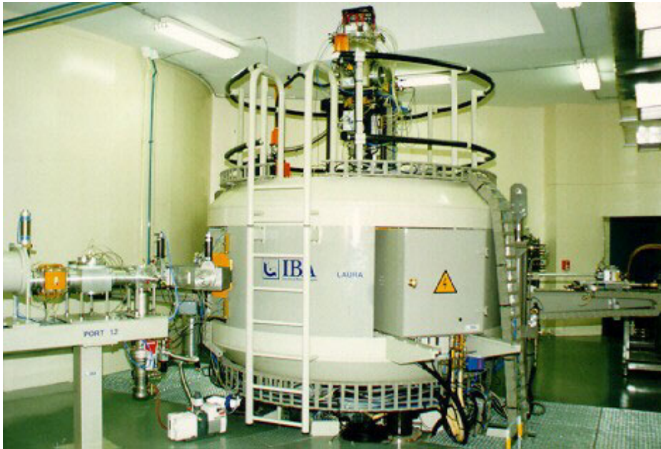
Figura 2.13 - Ciclotron do Instituto de Pesquisas Energéticas e Nucleares - IPEN utilizado para a produção de radioisótopos.
