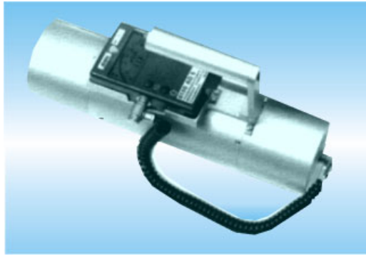
Figura 6.15 - Espectrômetro gama, com NaI(Tl) e analisador multicanal, portátil, que permite determinar a energia da radiação, obter o espectro e identificar o radionuclídeo.
