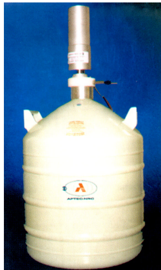
Figura 6.23 - Detector de germânio de alta pureza, resfriado a nitrogênio líquido, utilizado em técnicas de espectrometria X e gama, em medições de laboratório.
