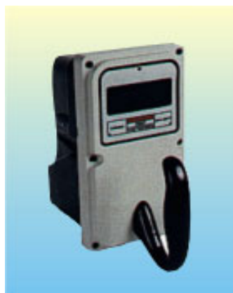
Figura 6.6 - Câmara de ionização, portátil, tipo “babyline”, com faixa de medição de 0,1 mR/h a 50 R/h ( 1 \mu\text{Sv/h} a 500 mSv/h), para detecção de radiações X, gama e beta, em instalações nucleares, clínicas de medicina nuclear, radiodiagnóstico e radioterapia.
