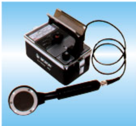
Figura 6.9 - Detectores G-M utilizados para medição de taxa de contagem ou convertidos para taxa de exposição e equivalente de dose ambiente.
