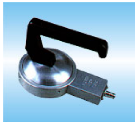
Figura 6.10 - Detector Geiger, tipo pancake, para medição de contaminação superficial com janela de mylar aluminizado, para radiação alfa, beta e gama.
